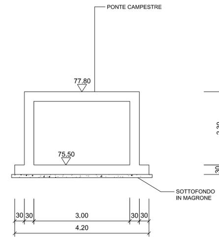
SEZIONE MURO LONGITUDINALE
