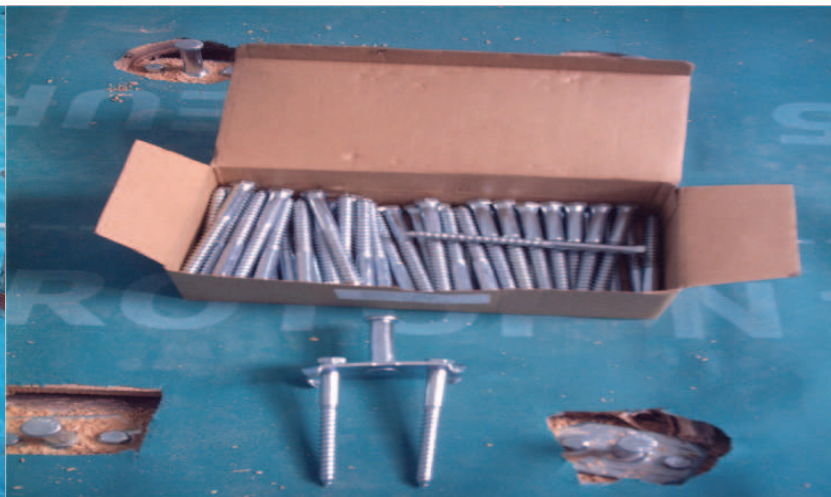
Tecnica esecutiva di recupero dei solai originari: guaina antivapore, sistema di ancoraggio (foto sopra) e imbragatura metallica delle travi principali (foto sotto).
