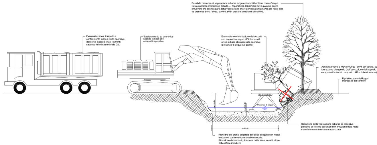
**SCHEMA DELLA DINAMICA DI DISSESTO IDROGEOLOGICO LUNGO I CORDI D'ACQUA**
