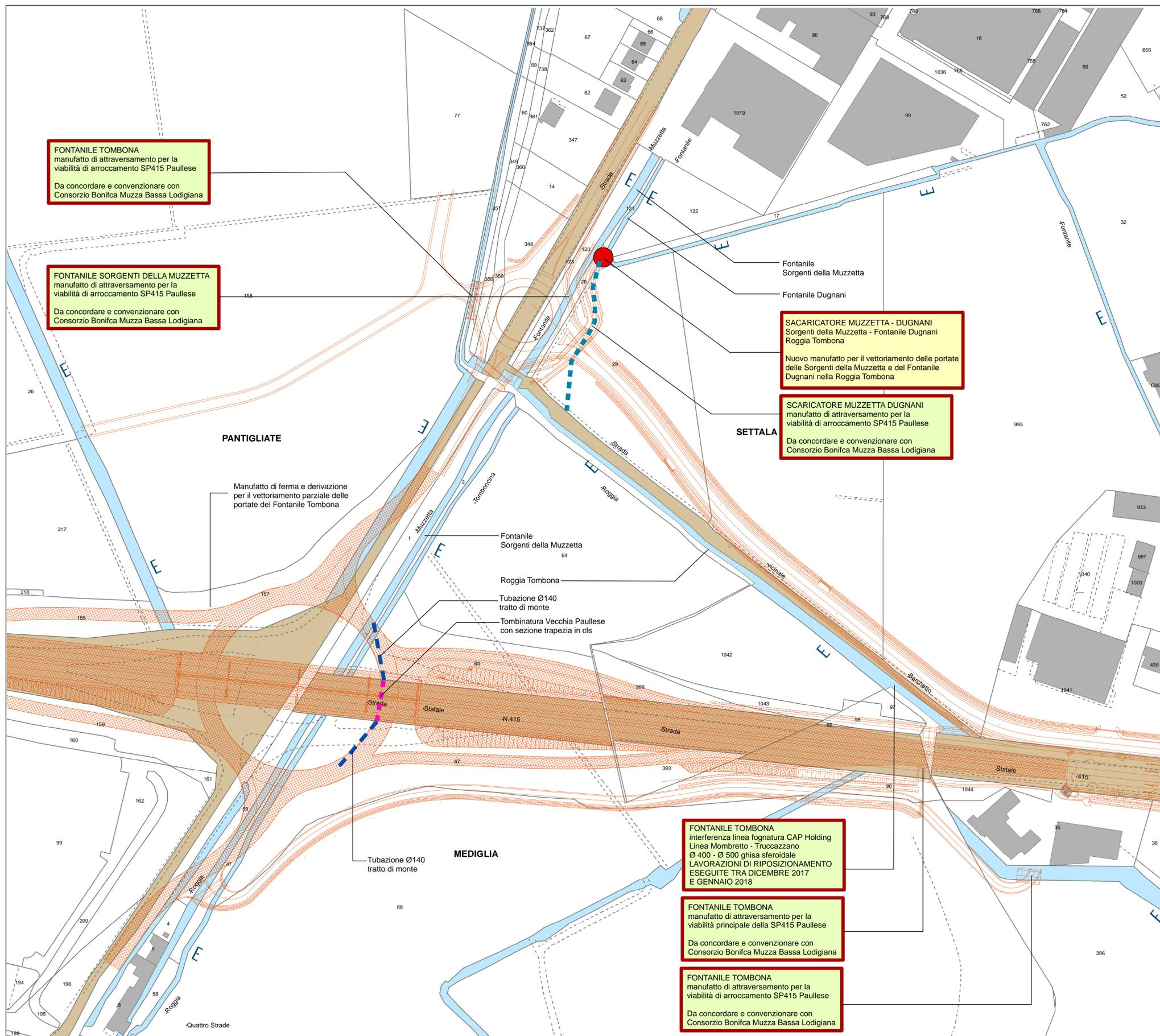
Schema delle interferenze tra la viabilità esistente e di progetto con le opere idrauliche per il vettoriamento delle portate delle Sorgenti della Muzzetta e Dugnani in Scolmatore Tombona
