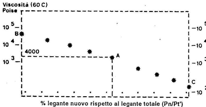
Indicando con A il punto le cui coordinate sono : il valore ottenuto di Pn/Pt ed il valore della viscosità di 4000 poise, l'intersezione della retta con l'asse verticale corrispondente al valore 100 dell'asse orizzontale, fornisce il valore C della viscosità del legante che deve essere aggiunto. Qualora non sia possibile ottenere il valore C con bitumi puri, si dovrà ricorrere a miscele bitumerigenerante. Si ricorda che la viscosità a 60°C di un bitume C.N.R. 80/100 è 2000 poise.
