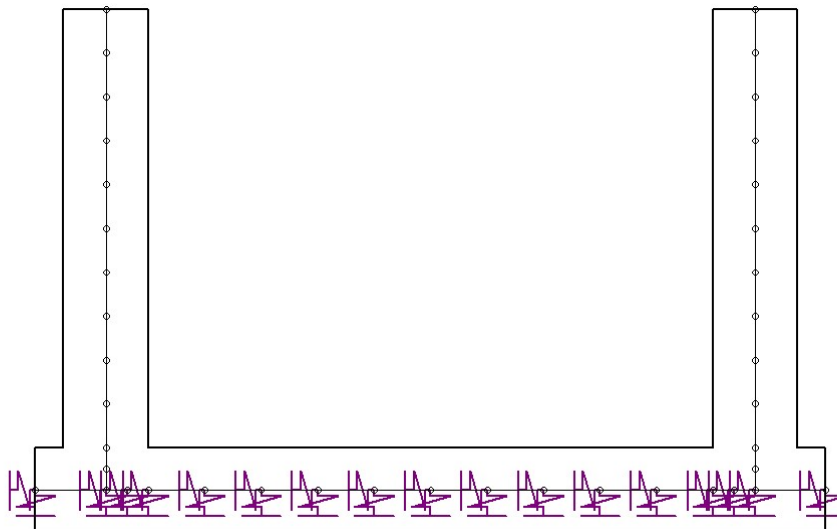
Immagine 4: molle elastiche simulanti il terreno
