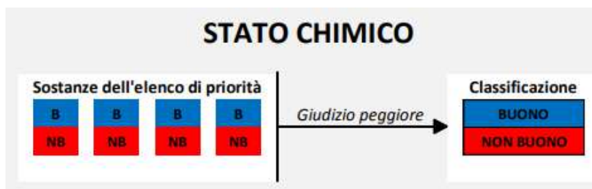
Figura 3.1.10 - Schema di riferimento per la classificazione dello stato chimico dei corsi d'acqua
