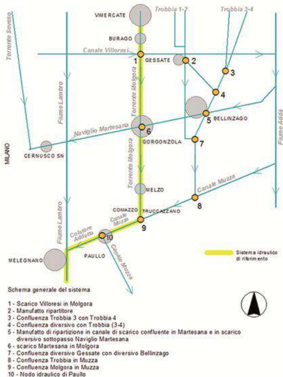
Figura 4.2.6 - Schema idraulico del sistema Molgora Muzza Addetta Lambro
