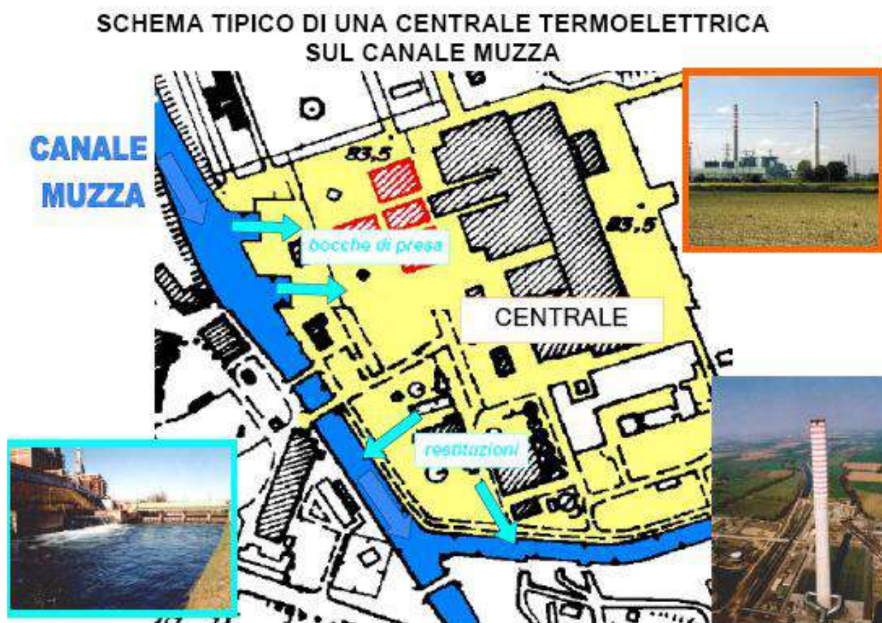
Figura 5.1.1 Schema tipico di una centrale termoelettrica sul canale Muzza
