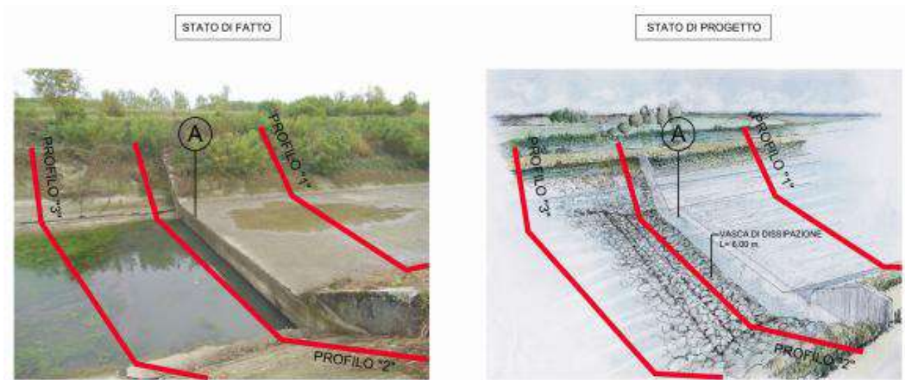
Fig. 6.1.53– Sezione vasca di dissipazione nell’ambito della riqualificazione e valorizzazione ambientale del Canale Allacciante ai fini della fruizione ambientale
